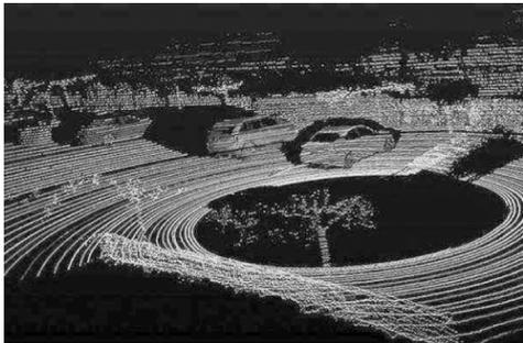
图 3-51 激光雷达点云图
