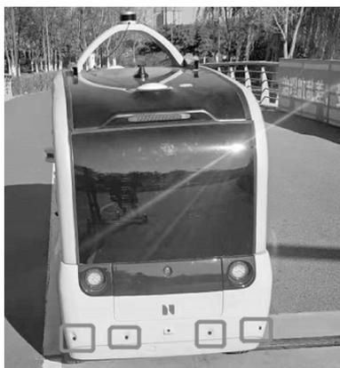
图 3-15 新石器自动驾驶无人车超声波雷达
