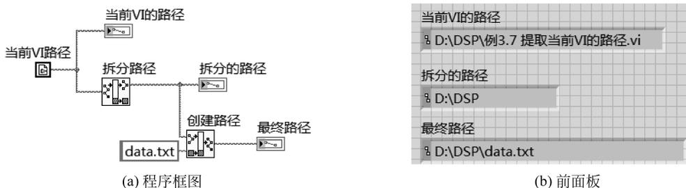
图 3.45 实现例 3.8 功能的 VI 的程序框图和前面板
