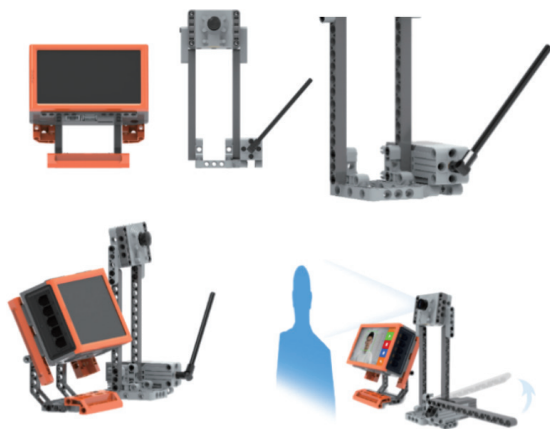
图 3-10 刷脸乘车装置硬件搭建
