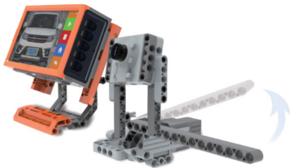
图 3-15 车牌识别硬件结构
