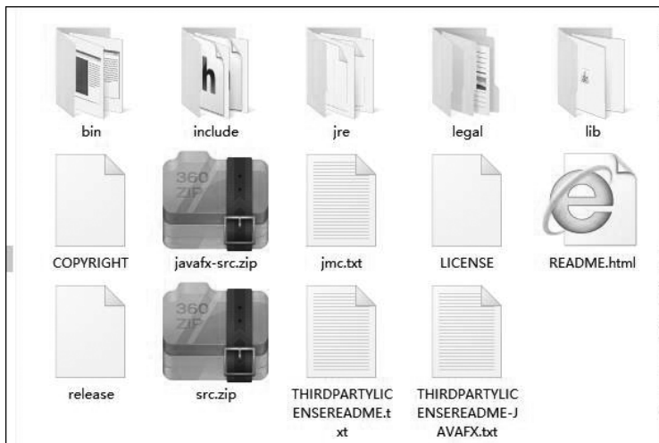
图 3.2 安装完成后的 JDK 目录结构
