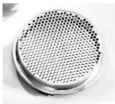
图 3.4 Polaroid 600 系列端面型测距声呐
