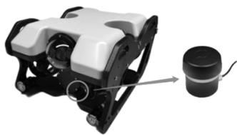
(a) 水下机器人和测距声呐实物图
