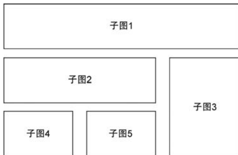
图 5-17 函数 subplot2grid() 创建子图效果
