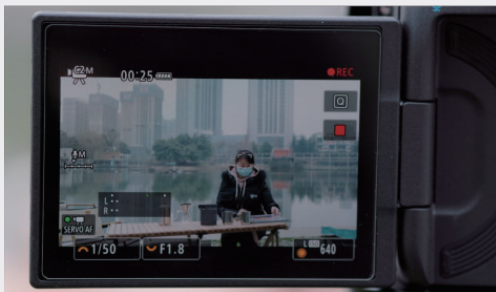
快门和光圈值不变，加装 ND 减光镜的效果
