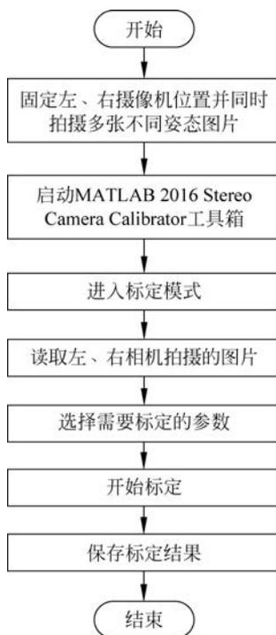
图 5-8 工具箱标定流程框图
