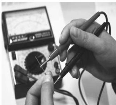
图 1-14 电阻的正确测量方法
