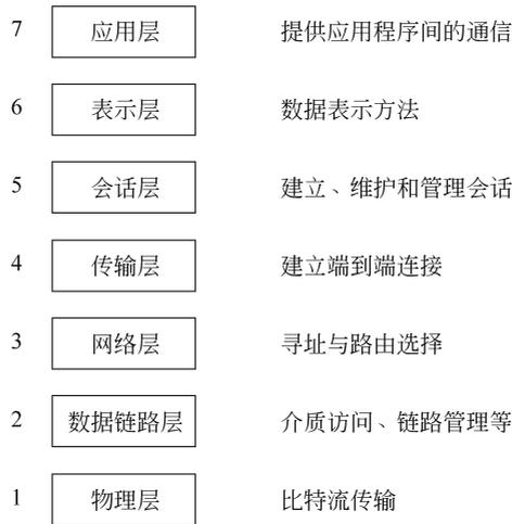
图 1-9 OSI 的分层模型
