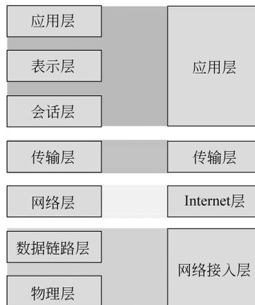
图 1-11 TCP/IP 模型与 OSI 模型的对应关系
