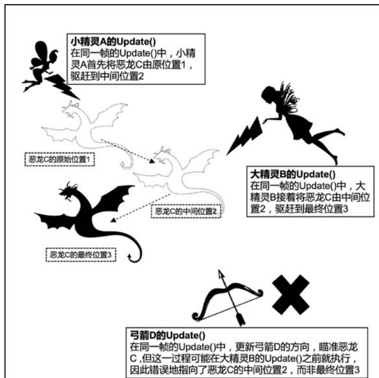
图 5.27 仅使用 Update() 函数体,无法确保正确处理对象间的多重影响
