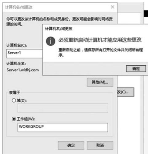
图 5-8 配置服务器的完整计算机名称
