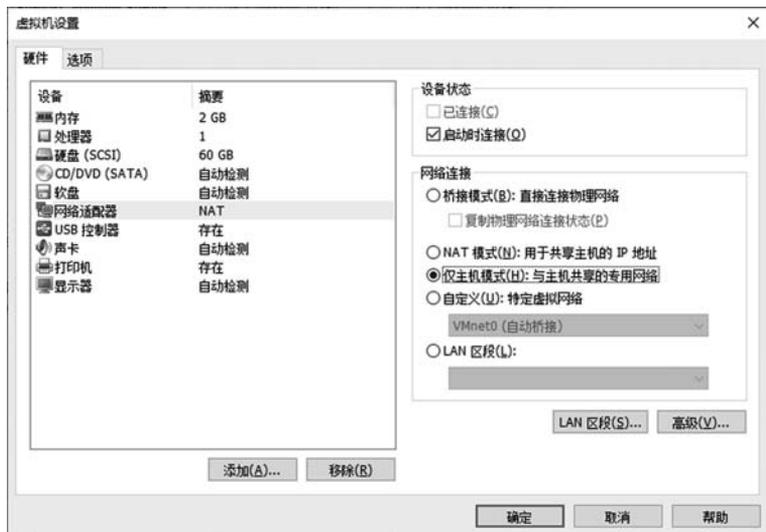
图 5-5 将虚拟机的“网络连接”设置为 Host Only 模式
