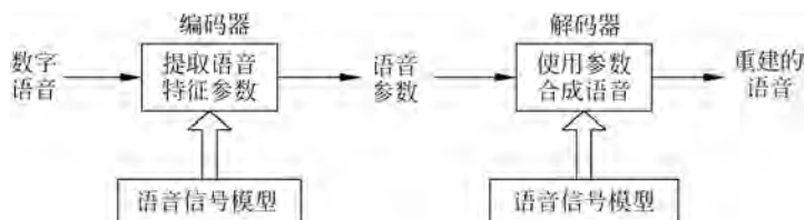
图 5.49 参数编码/解码原理
