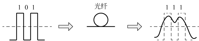
图 3.20 光纤色散导致码间干扰
