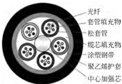
图 3-10 五芯光缆的剖面示意图
