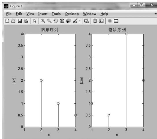
图 3-4 基于 mod 函数实现的圆周位移
