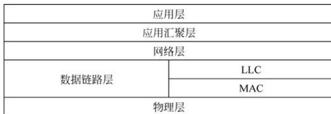
图 3-5-3 ZigBee 协议框架
