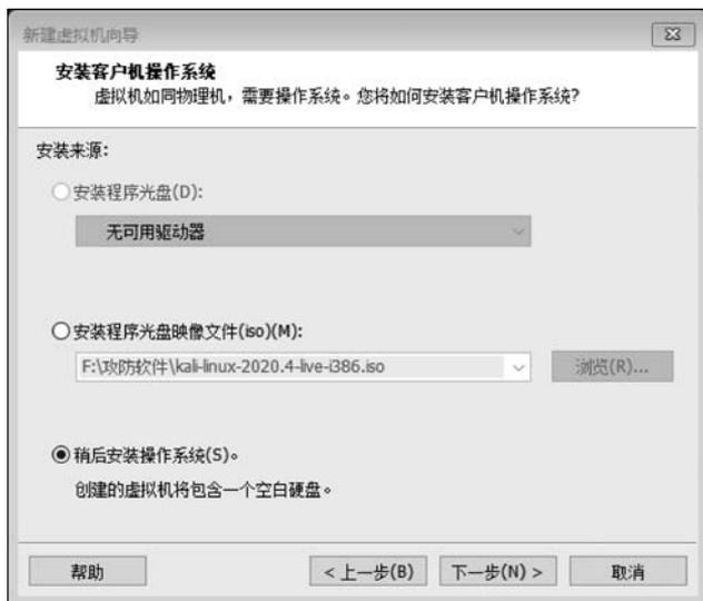
图 5.3 稍后安装操作系统
