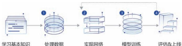
图 5.10 使用飞桨框架构建神经网络过程
