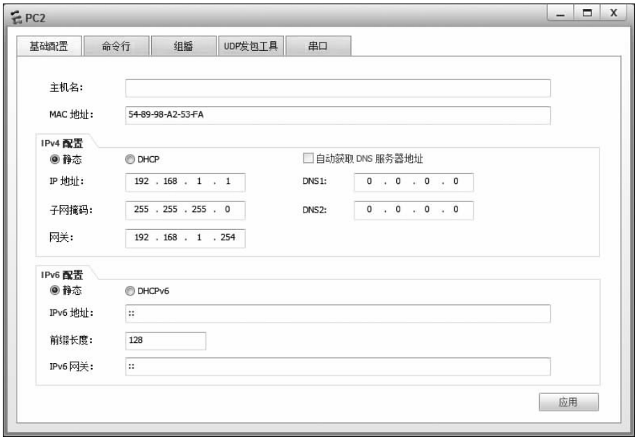
图 3.17 终端 PC2 配置的 IP 地址、子网掩码和默认网关地址
