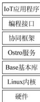
图 3-18 Ostro 物联网操作系统的整体架构
